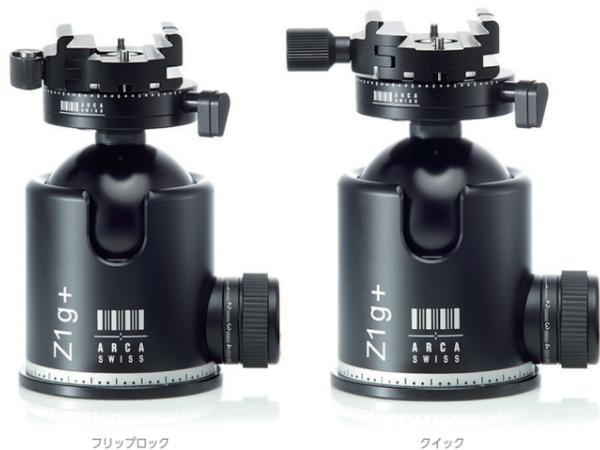
パノラマプレートを標準装備、大幅な軽量化を達成しながら、超望遠レンズや中判・大判カメラまでパーフェクトにサポートする自由雲台です。Z1g+ はスムーズな動きとカメラの正確なポジショニングを提供します。MRGC（モーション・リレーテッド・グラビティ・コントロール）機構は水平、垂直方向でそれぞれ違うフリクション特性を1つのボールで実現しました。水平方向の動きではその摩擦抵抗は一定に保たれますが、垂直方向では俯瞰方向に傾くほど摩擦抵抗が増大していきます。
