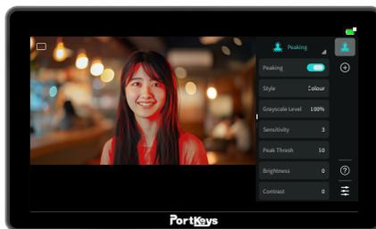
ポートレート撮影:ポートレートを撮影する際、ピーキング機能を使って被写体の目のシャープさを確認できます。フォーカスリングを調整し、目に表示される高輝度のマークが安定していることを確認することで、正確に目にピントが合っていることを示します。
