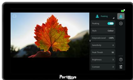
モニター機能 > フォーカス > ピーキングでピーキングを有効にすると、ピントが合っている部分がハイライト表示されます。現在の撮影環境に適したハイライトカラーを選択してください。感度を調整してハイライト範囲を増減させ、その後、フォーカスリングを動かしてリアルタイムでピントを合わせ、目的のフォーカスエリアがはっきりと表示されるまで調整します。
