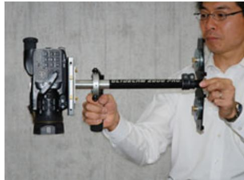
垂直軸のバランスがとれているかを【落下テスト】で確認します。
