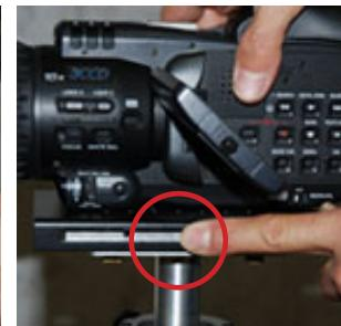
重心位置の印とセンターを合わせて、ミッド・プレートに装着します。
