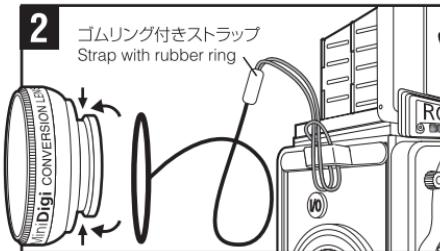
コンバージョンレンズは、アダプターリングに近付けるだけで装着できます。
