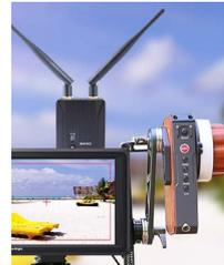
FW279Sは、3G-SDI、4K HDMI入力およびループアウトを備えているため、ライブ映像を表示するだけでなく、同時に他のモニターに送信することもできます。元のビデオ品質を維持しながら、同時に複数のディスプレイにライブ画像を表示することができます。
