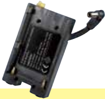
DLED2-BSU DLED2-D /-BI用バッテリーシュー 適用バッテリー: Sony BPU-60 (14.4V/56Wh)
