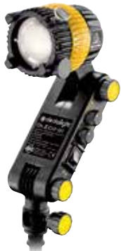
DLED2-BI Ⓐと同じイメージですがバイカラーバージョンでは色変化なしで調光するとともに色温度変化可能範囲は2800K -6000Kまでの間です。2つのノブの内、一方は減光をおこない、もう片方は色温度の調整をおこないます。
