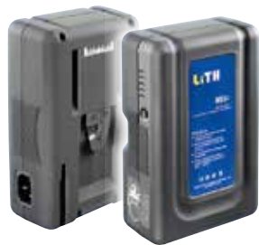
LiTH 95SI battery, 95 Wh ■ Vマウント ■ 14.8V 95 Wh ■ 最大放電電流: 10A ■ 充電入力電圧: 90V - 240V (充電用ケーブル付きーただし必要ならば国別の電圧に対応するケーブルと交換可能) ■ 統合型充電器 ■ すべてのVマウントプレートに対応 ■ 5ピンコネクターでカメラおよび他のVロック装備の機器と接続可能
